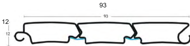
3333.AN /antracit/ 3333.SE /šedá/ 12 mm roletková lamela, šířka=93mm, délka=2000mm
