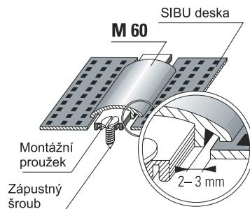
Nelepící dvoudílný ukončovací nebo meziprofil ve formátu 2660 x 25 mm. Desky lepit ve vzdálenosti 23 mm, poté mechanicky upevnit prostřednictvím montážních lišť k podkladu a nastrčit krycí profil.
