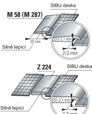
Silně lepící ukončovací eventualně středový profil ve formátu 2705 x 22 mm (M 287 2705 x 28 mm). Tyto profily jsou určeny jak pro savé tak i nesavé podklady, přičemž se doporučují nesavé podklady.
