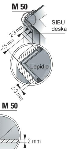
Nelepící ohebný rohový profil pro vnitřní a vnější rohy ve formátu 2705 x 50 mm. Rohový profil nalepit montážním lepidlem na podklad.
